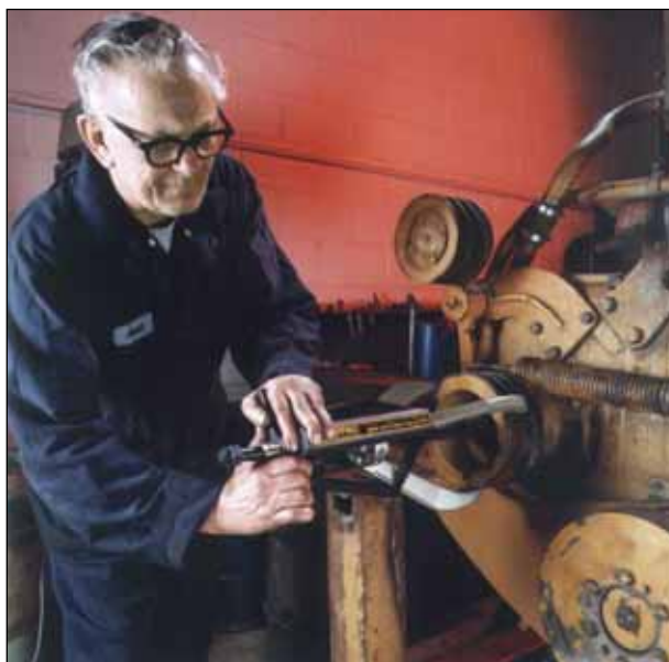
◀ 3-vetojalkaista EP-104 asemoidaan kiinni dieselmoottorin hihnapyörään.
