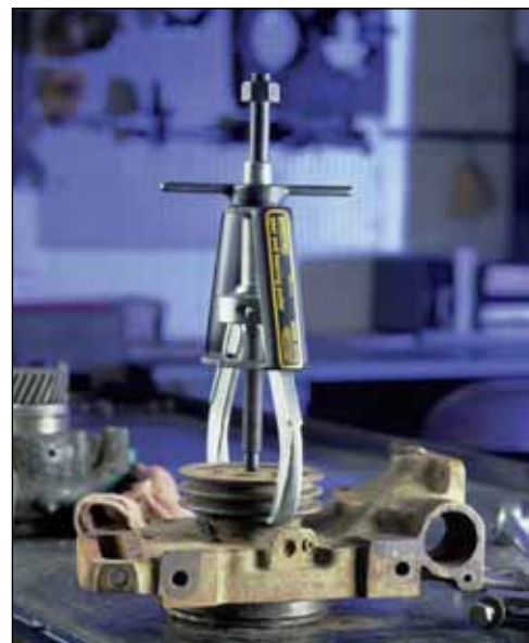
▲ EP-204 ulosvetäjällä irroitetaan hihnapyörää.
