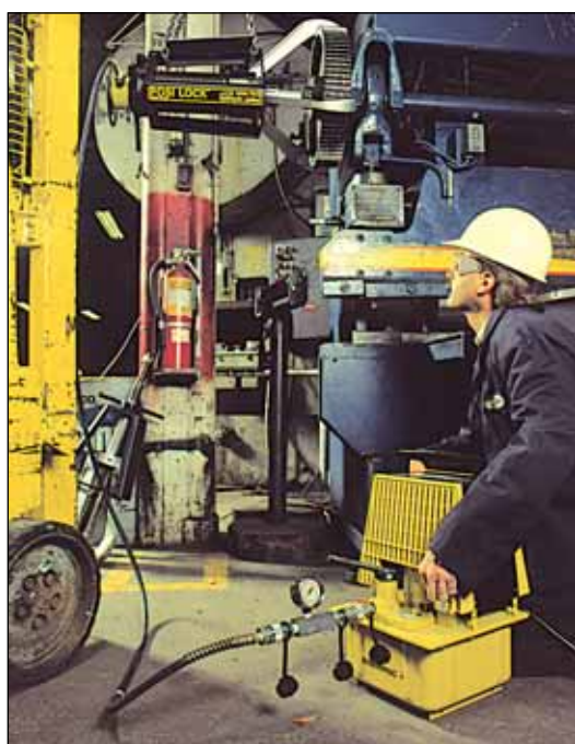
◀ EPHR-116, 50 tonnin hydraulinen Posi Lock ulosvedin irrottamassa hammaspyörää.
