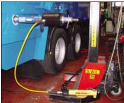
◀ RACH-306, jota käytetään P-392 käsipumpulla, käytetään keräysajoneuvojen ruostuneiden tappien vetämiseen.
